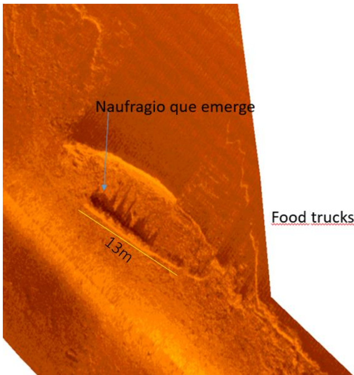
Ilustración 73. Sector 6 naufragio al oeste de la plazoleta de Food Trucks, imagen subacuática con SSS.
